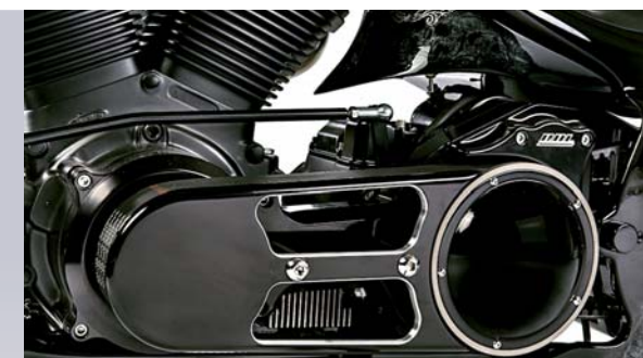
Beltabdeckung mit Gucklöchern. Dahinter der Riemen, der Motor und Getriebe verbindet
