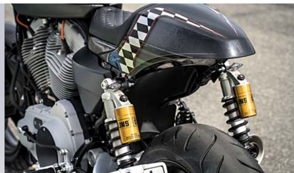
Feinfühlige Öhlins-Dämpfer heben das Heck an. Ein schlankes Design unterstreicht den Racing-Auftritt
