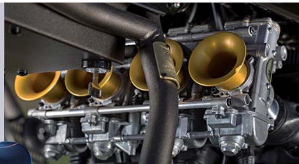
Vier Mikuni TMR-Flachschieber schnüffeln durch goldene Trichter. Anreißen erwünscht
